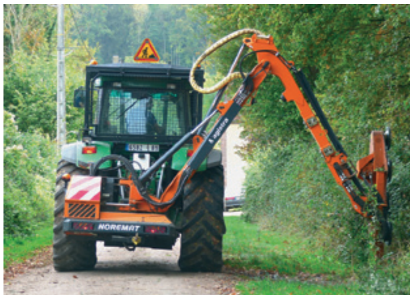
Elagage de haies bordant la voirie à l'aide d'un lamier à couteaux rétractables. Ce type de lamier convient pour des branchages de petit diamètre, le résultat est plus soigné qu'avec un rotor car le bois n'est pas déchiqueté.
