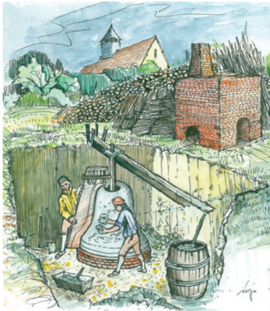
Fabrication sur place de la cloche Lucie en 1678, avec le four, la réserve de bois et la fosse pour la coulée. A l'arrière plan, l'église de Merry-la-Vallée avec son ancien clocher
