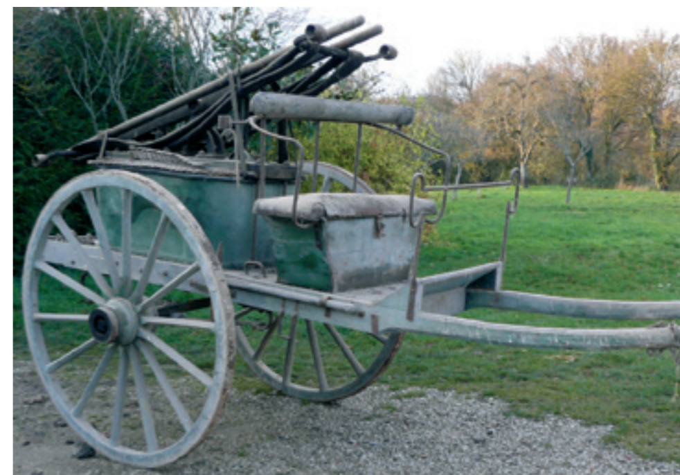
L'ancien véhicule hippomobile des sapeurs-pompiers de Merry-la-Vallée, avec son réservoir en cuivre et au-dessus la pompe à balancier et le tuyau
